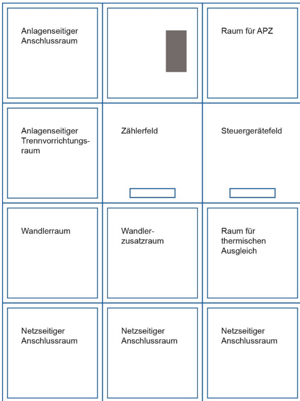
Bild 8: Beispiel - Wandlermessung 200 A in Neuanlagen
