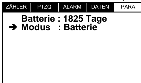
Abbildung 12: Parametrierung der Batterielebensdauer und des Stromversorgungsmodus
